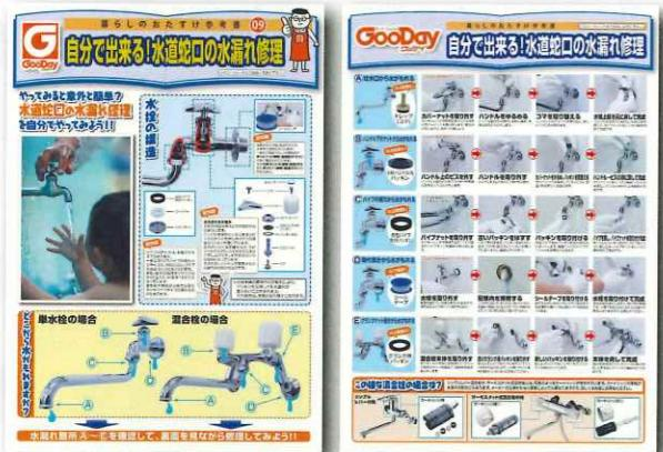
また、作業開始時は水道元栓を自分の部屋のものか確認した上、完全に閉めます。(集合住宅の場合は玄関横のパイプスペース内にあります)
